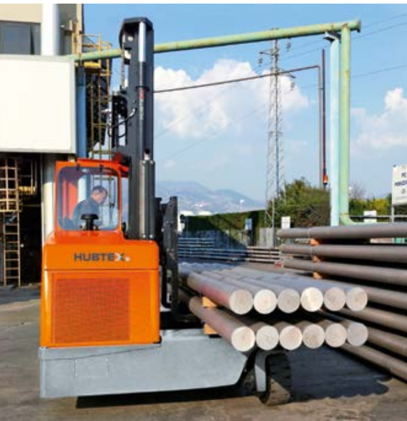
Weichbereifter Diesel-Vierwege-Seitenstapler Diesel-Forway-Sideloader with soft tyres
