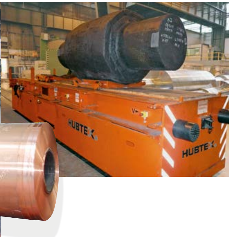
Gleiswagen für den Transport von Schmiedeteilen, Tragfähigkeit von 10 – 230 t Rail car for transport of forged pieces, capacities from 10 – 230 t
