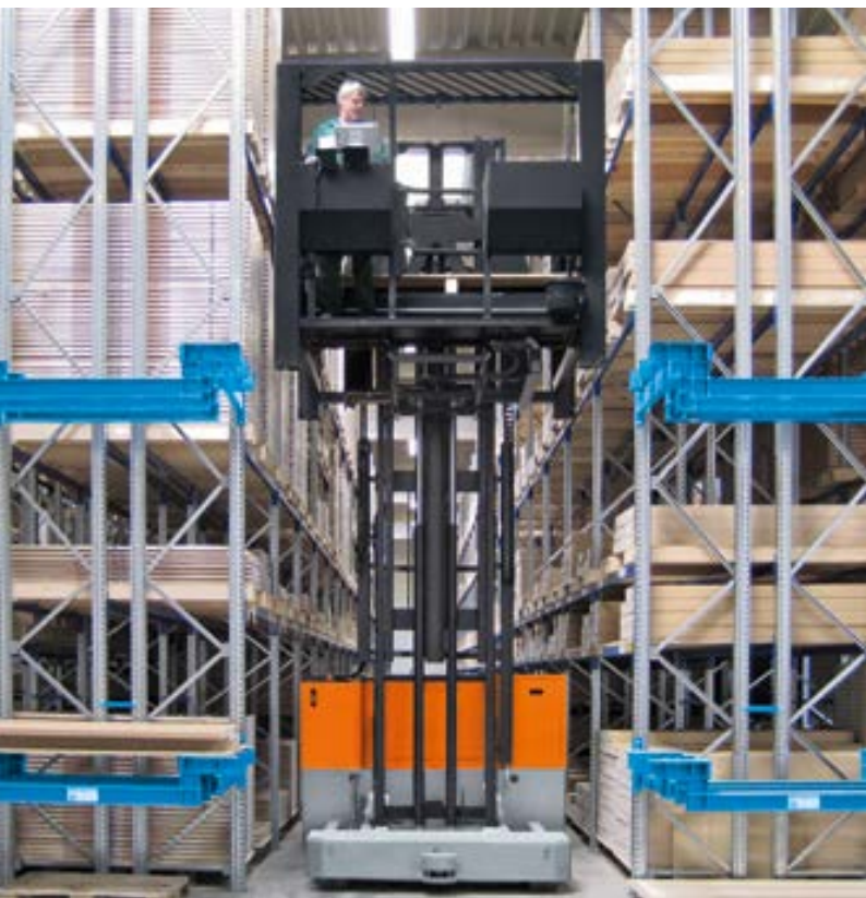
MK beim Kommissionieren von Türen MK for the order-picking of doors
