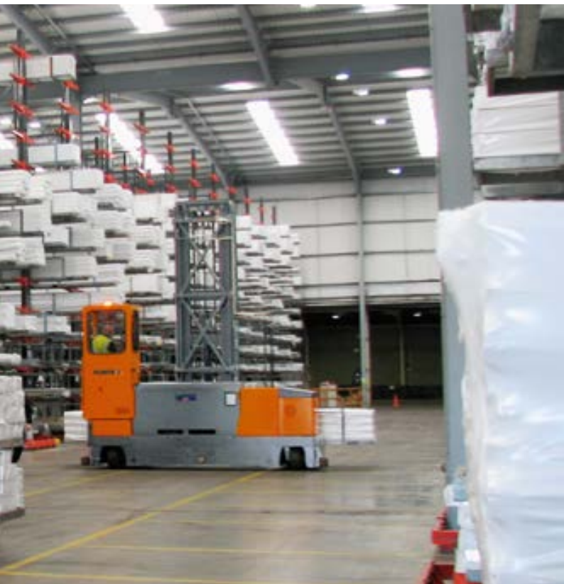
Mehrwege-Seitenstapler für das Handling von Profilkassetten Multidirectional-Sideloader for handling of profile boxes
