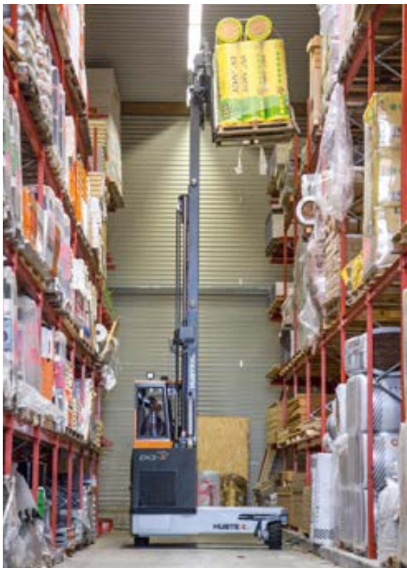
Vierwegestapler mit energieeffizientem Dieselantrieb Fourway sideloader with energy-efficient diesel engine
