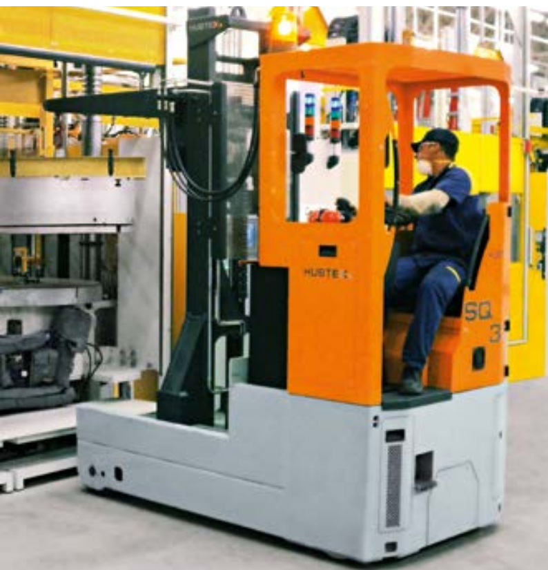
Schubmaststapler für das Handling von Reifenformen Reach truck for handling of tyre moulds
