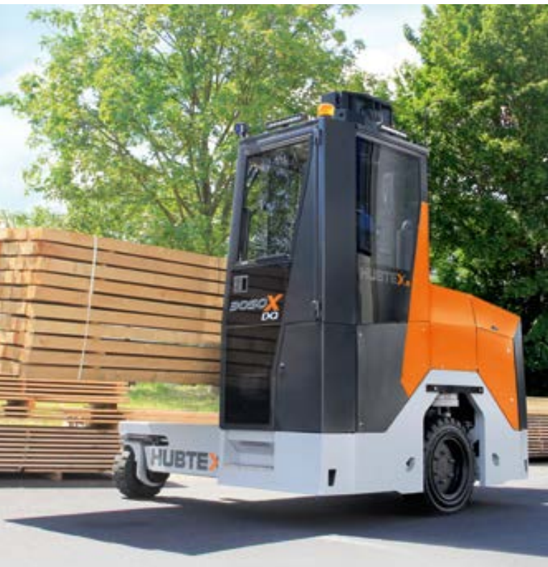
Diesel-Vierwege-Seitenstapler für den Innen- und Außeneinsatz Diesel-Fourway Sideloader for combined indoor and outdoor use
