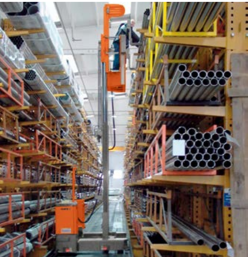
Mehrwege-Seitenstapler für das Kommissionieren von Röhren und Profilen Multidirectional-Sideloader for order-picking of tubes and pipes
