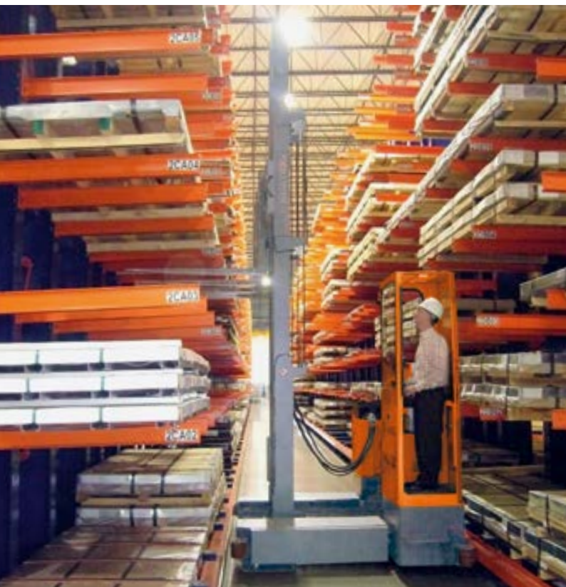
Mehrwege-Seitenstapler im Blechlager Multidirectional-Sideloader in sheet metal stockyard
