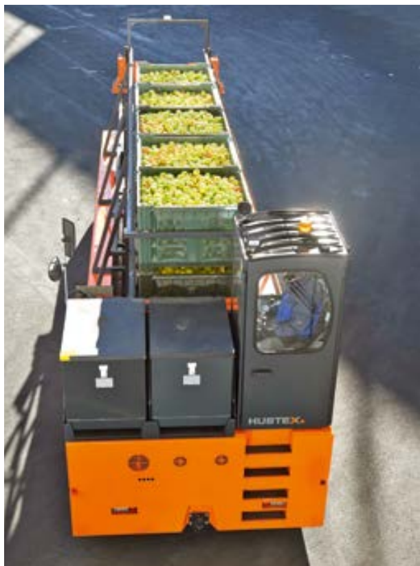
Innenlader beim Transport von Apfelkisten Inloader transports boxes with apples
