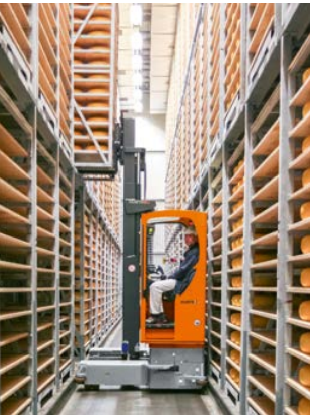
Mehrwege-Seitenstapler beim Kommissionieren von Käseleiben Multidirectional-Sideloader in a cheese warehouse
