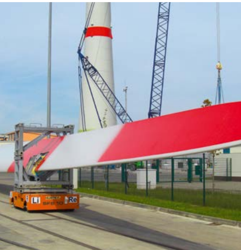
Plattformwagen für den Transport von Rotorblättern für Windkraftanlagen Platform truck for handling of rotor blades of wind turbines
