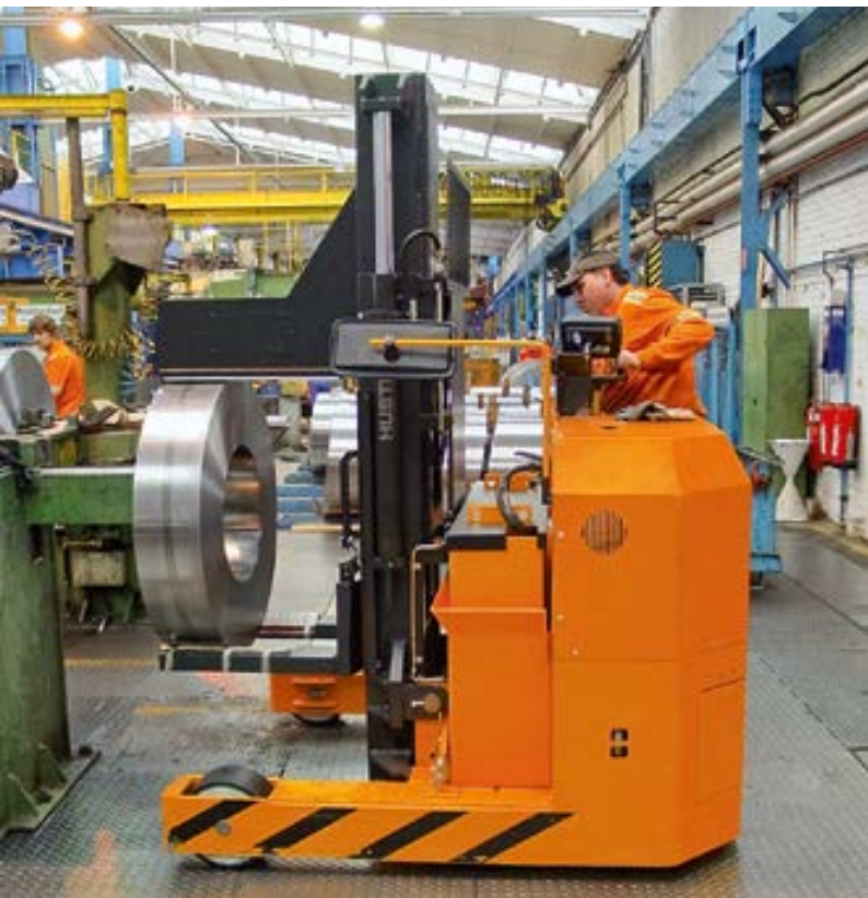
Transporter zur Ver- und Entsorgung von Stahl-Coils an einer Längsteilanlage Truck for manipulation of steel coils at a slitting line
