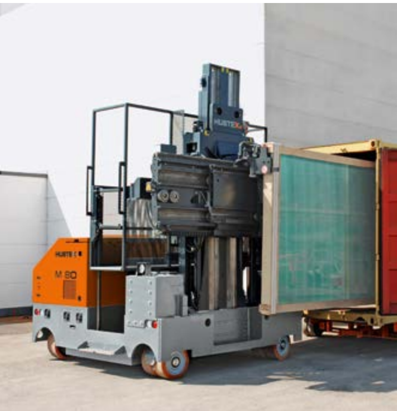
Be- und Entladung von verpackten Glaspaketen in/aus Seecontainern Loading/Unloading of packed glass packs into/out of sea containers
