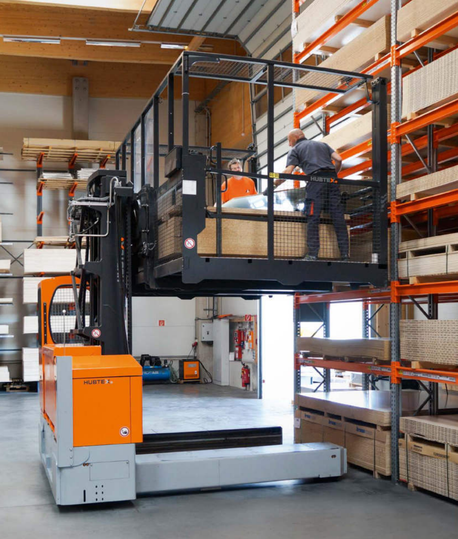
Mehrwege-Seitenstapler mit aufnehmbarer Kommissionierplattform
